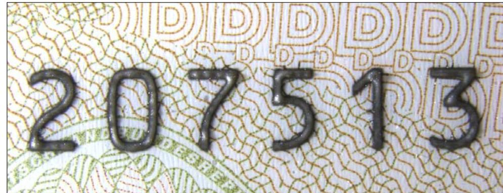
Integration der Ausstellungsdaten in das Kartenmaterial durch Wechselwirkung der Laserstrahlung mit speziell pigmentierten Polycarbonat-Folien (teilweise taktil)
